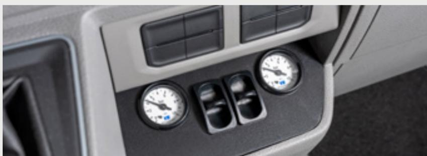
**Confort de conduite et sécurité maximaux.** La suspension pneumatique à 2 canaux de haute qualité fait partie de l'équipement de série de tous les camping-cars KNAUS sur VW CRAFTER.
