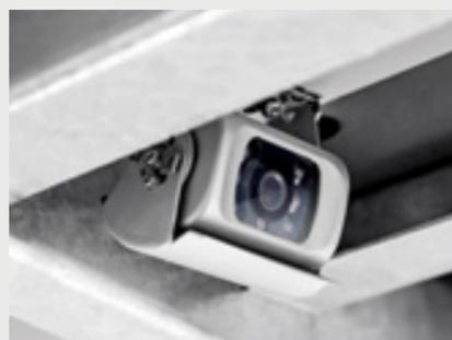
**Caméra à soupape d'égout & électr. Robinet de vidange.** Le SUN I 3 essieux peut être équipé en option d'une caméra à clapet anti-retour pour simplifier le positionnement du véhicule sur le drain. La vanne de vidange électrique standard peut être commandée de manière pratique depuis la cabine (En fonction du modèle / Optionnel).
