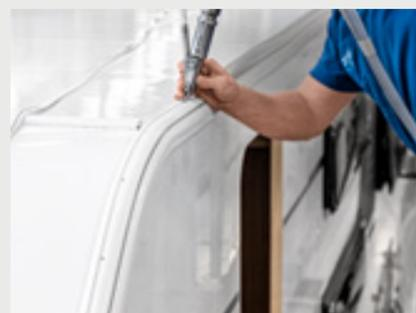
**Cadre Pro Tec stable.** Le cadre Pro.Tec est une barre en aluminium profilée et particulièrement massive qui relie les parois latérales, avant, arrière et le toit. Il améliore la stabilité de la structure et donc la durée de vie de tout le véhicule. Particularité intéressante : sur le cadre Pro.Tec, un espace est intégré pour le joint d'étanchéité. Celui-ci ne pourra plus se dilater, l'aspect final est esthétique (camping-cars / en fonction du modèle).
