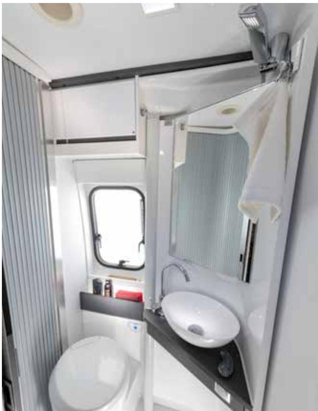
La solution Duplex permet, à la carte, de transformer la pièce en cabine de douche ou en ensemble wc/lavabo, grâce au simple pivotement d'une paroi.
