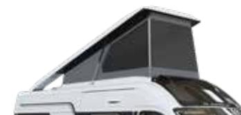
Sur les modèles 640 un mécanisme de pivot ingénieux, avec bras latéraux allongés, permet une ouverture/fermeture de qualité. Le toit relevable s'intègre parfaitement à la silhouette du fourgon lorsqu'il est fermé et assure une très bonne stabilité au vent lorsqu'il est déployé.
