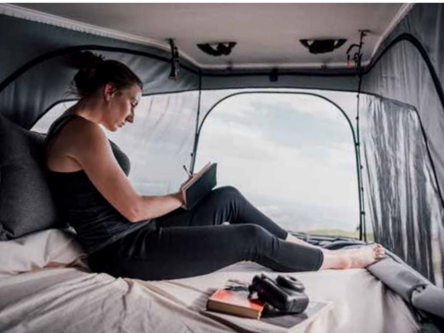
Le couchage est de 120x200 cm avec un matelas confortable, des espaces de rangement pratiques avec ports USB et lampes de lecture. La tente de toit est faite en matériaux acryliques, pour en assurer une bonne isolation, résistance à l'eau et respirabilité.
