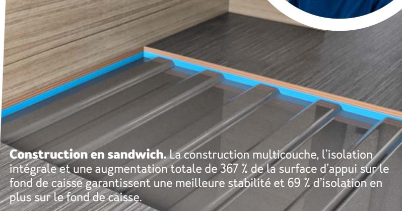
**Construction en sandwich.** La construction multicouche, l'isolation intégrale et une augmentation totale de 367 % de la surface d'appui sur le fond de caisse garantissent une meilleure stabilité et 69 % d'isolation en plus sur le fond de caisse.
