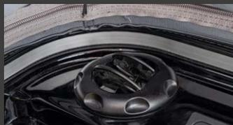
1. Sortie d'air chaud standard pour des températures agréables dans le toit relevable.
