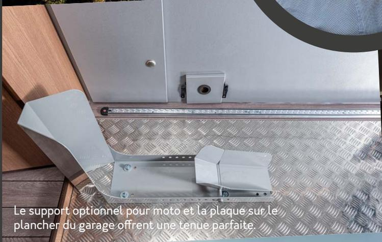
Le support optionnel pour moto et la plaqué sur le plancher du garage offrent une tenue parfaite.
