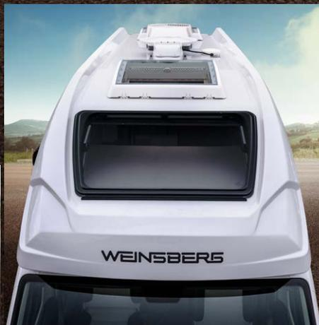
Fenêtre panoramique et fenêtre à charnière dans l'arc. Offre une ambiance lumineuse sensationnelle et une circulation d'air frais optimale dans le véhicule.
