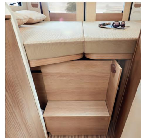
▲ Le modèle 600 DB dispose d'un marche-pied coulissant pour faciliter l'accès au lit. Celui-ci fait également office de séparation avec l'espace garage.
