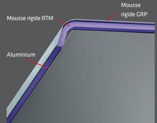
☒ Malibu Van à toit relevable hybride avec le meilleur concept d'isolation de la catégorie, de construction sandwich et avec un faible poids propre
